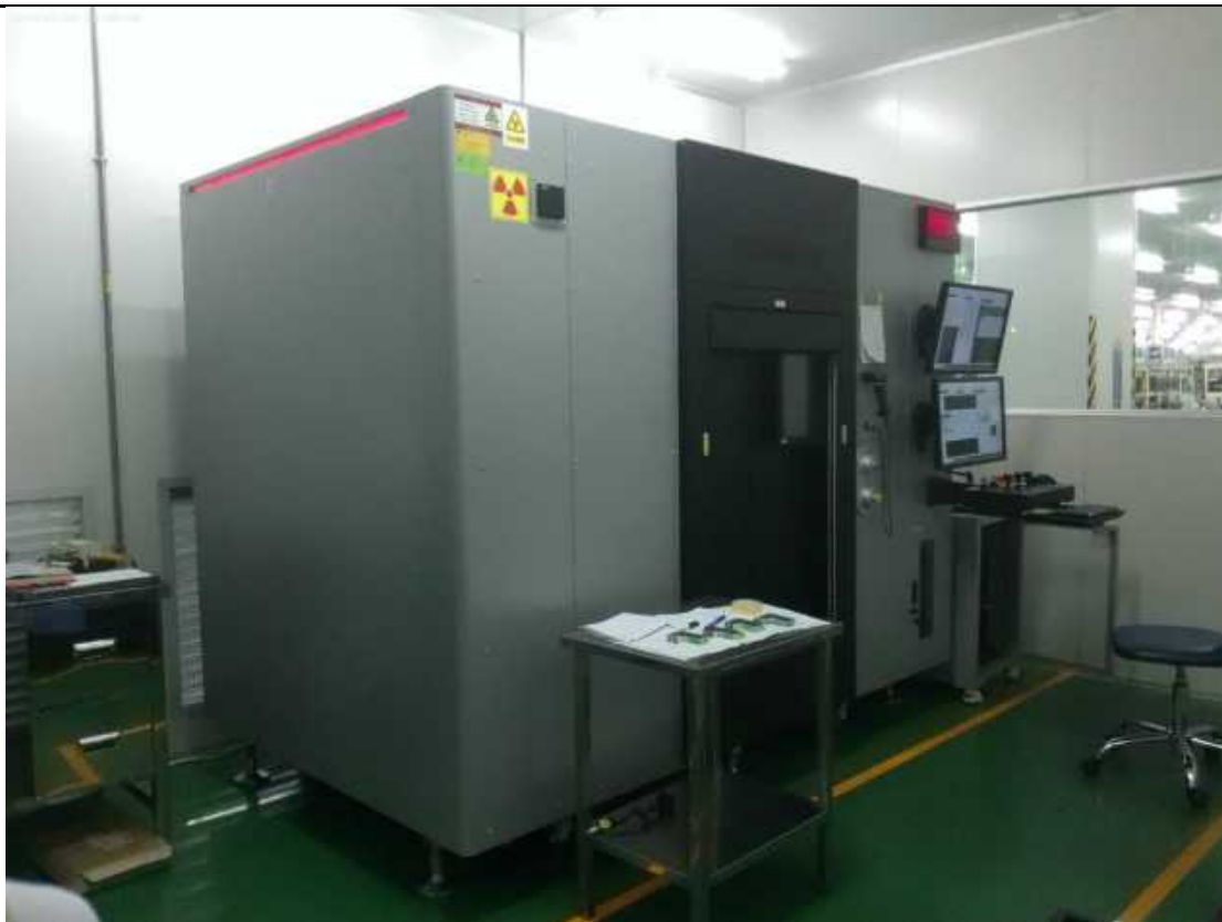
图 2-1 本项目 X-eye 7000BN 型工业 CT 装置实物图
