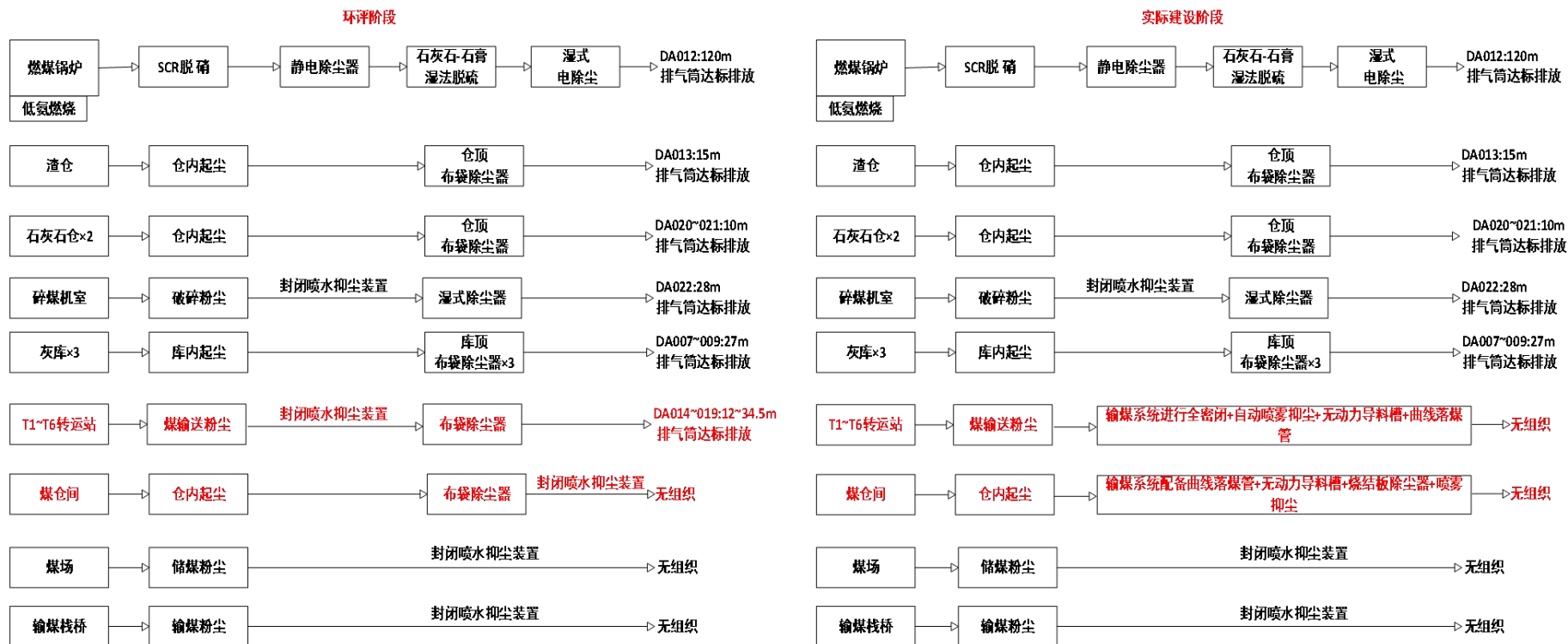
图3.6-1 废气处理工艺流程变换前后对比图
