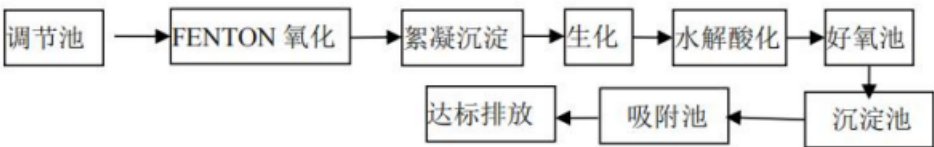
图 4-2 小镇北区污水处理站废水处理工艺流程图
